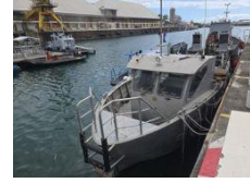
Lot.36 Navire de charge Monocoque ODC MARINE - numéro immatriculation RU934382 - "SEAWORKS" avec grue HYDROARMOR 071016 - année de construction 2016 - moteur IVECO diesel 350 cv/257,76 kw -en panne
